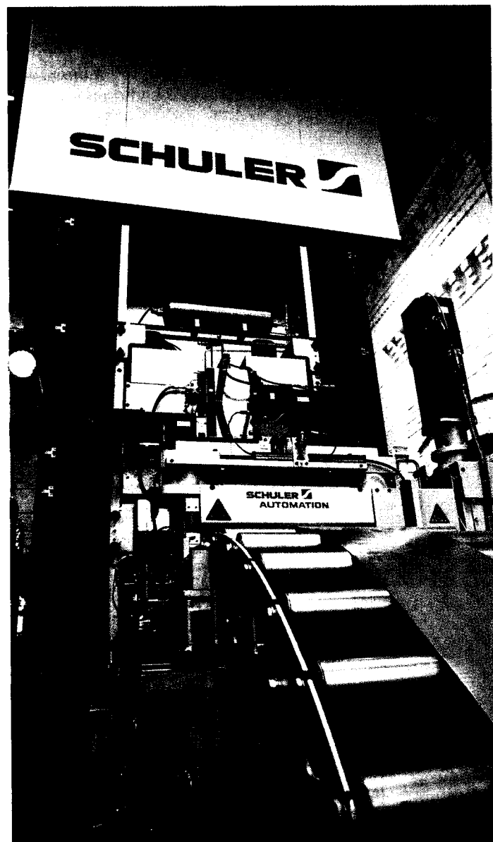
Die Schuler-Servopresse verfügt über eine Presskraft von 250 Tonnen. Zur hochproduktiven Gesamtlösung gehört zudem ein passender Walzenvorschub.
